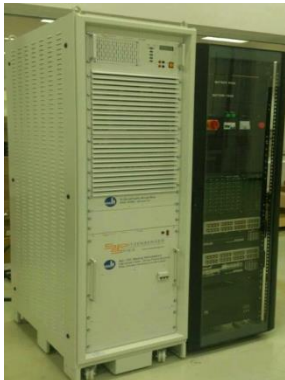
图 8 三级同步发电机硬件在环实时仿真系统
